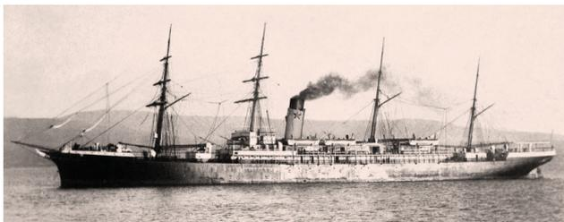
„Aufgrund des doppelten Bodens, der wasserdichten Schotten, der Anzahl von Rettungsbooten und der Tatsache, dass die Friesland einen Ballast von bis zu 1000 Tonnen aufnehmen konnte, galt sie als eines der sichersten Schiffe ihrer Zeit. Die Passagierkapazitäten lagen bei 226 Passagieren der Ersten, 102 der Zweiten und 600 der dritten Klasse. Die Höchstgeschwindigkeit war 15 Knoten (28 km/h).“
