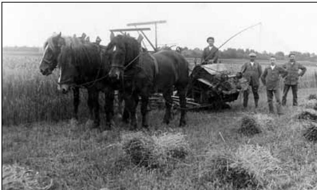
Foto unten: Auf dem Merreter Feld, dreispänniger Selbstbinder mit Windmühlenflügel zum Mähen und Binden von Getreide, es gab noch keinen Pick up. Im Hintergrund die Bahnlinie Mönchengladbach-Dalheim (Eiserner Rhein).
